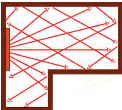
Bei der Deckenmontage ist darauf zu achten, dass die Leistung auf zwei oder mehrere Paneele aufzuteilen ist. Die Leistung ist immer von der Raumgröße und -höhe abhängig.
